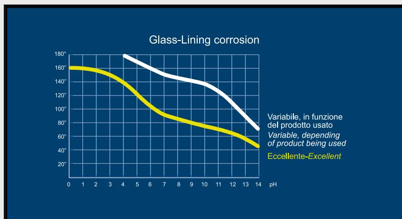
*Il grafico mostra la resistenza alla corrosione dello smalto G 2208 in funzione della temperatura e del pH.*
