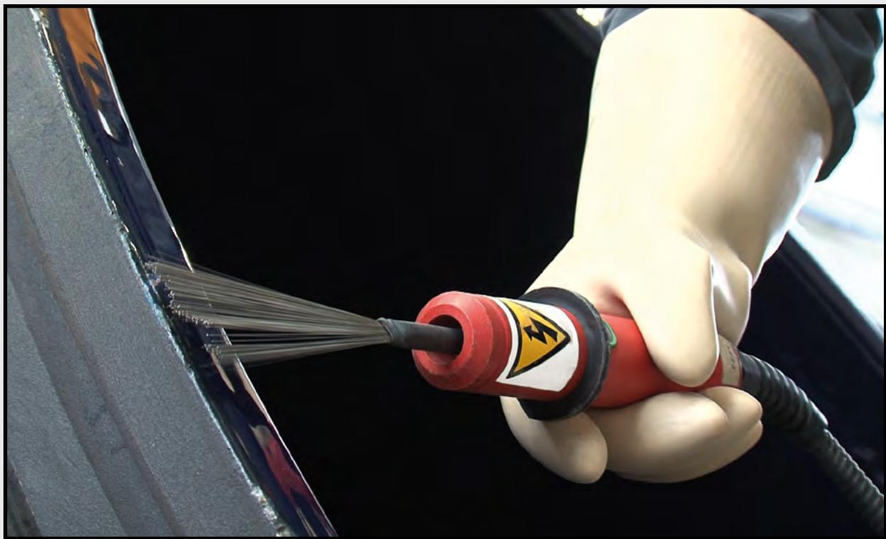
Dopo smaltatura vengono eseguiti controlli di spessore ed integrità del rivestimento.
