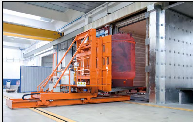
I forni elettrici computerizzati, di tipo verticale e le camere di preriscaldo e raffreddamento, garantiscono una qualità di smaltatura ai massimi livelli, priva di contaminazioni e micro difetti, per apparecchi di capacità fino a 40.000 litri.
